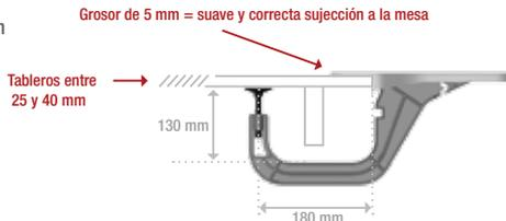
1. Alinear el extremo del brazo multi-posición en su alojamiento en la parte inferior de la superficie de apoyo (en posición izquierda, central o derecha)
